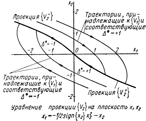
Рис. 7.22. Проекция траекторий, принадлежащих к \{V_1\} на плоскость x_1, x_2
