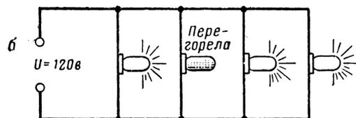
Если разрыв произойдет в общей цепи (рис. 31, а), то все лампочки погаснут. Если перегорит одна лампочка
