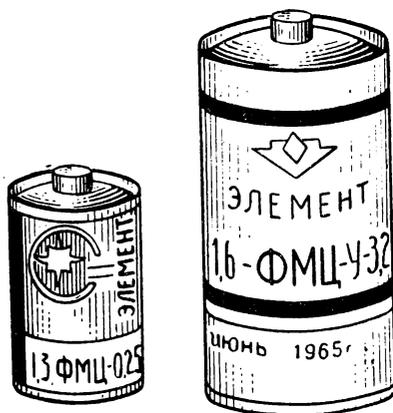
Рис. 204. Малогабаритные сухие элементы марганцевой системы
