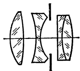
Рис. IV, 8. Оптическая схема объектива «Тессар»
