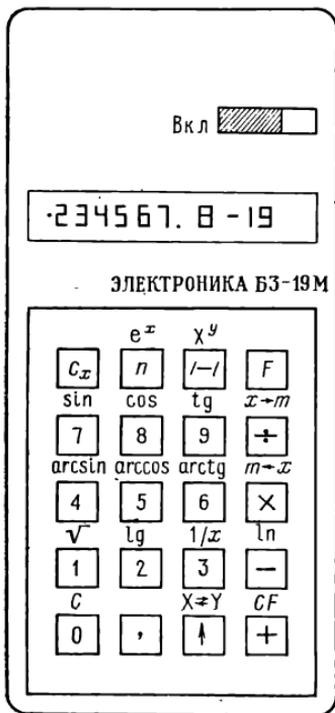
Рис. 1.2. Внешний вид микрокалькулятора Электроника БЗ-19М с обратной бесскобочной логикой вычислений
