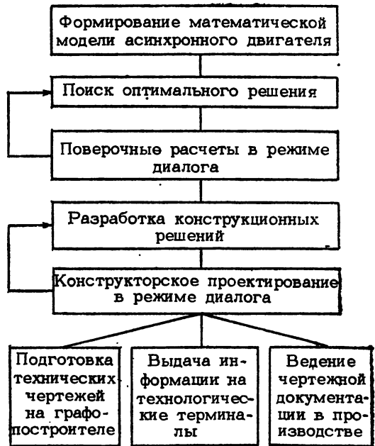
Рис. 23.44. Структурная схема проектирования асинхронных двигателей с использованием САПР
