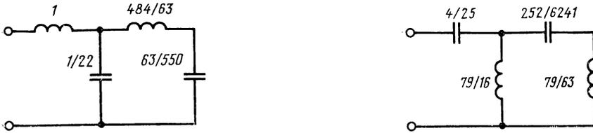
Рис. 9.11. Схемы двухполусников типа Кауэра
