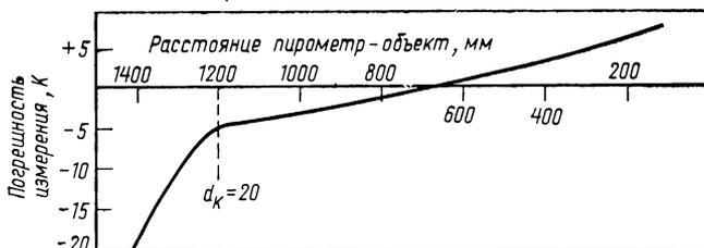
Рис. 9.29. Погрешность измерения пирометра излучения в зависимости от расстояния до объекта при диаметре измерительного поля объекта  $D = 60$  мм. Показатель визирования  $d_k = 20$  при расстоянии  $a = 1200$  мм
