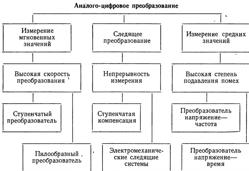
Рис. 4.26. Наиболее распространенные методы аналого-цифровых преобразований электрических величин
