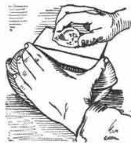
Рис. 11. Шлифованье доски пемзой.
