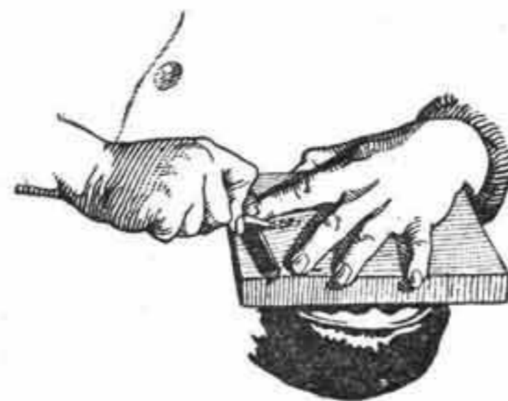
Рис. 44. Прием вынимания белых мест.
