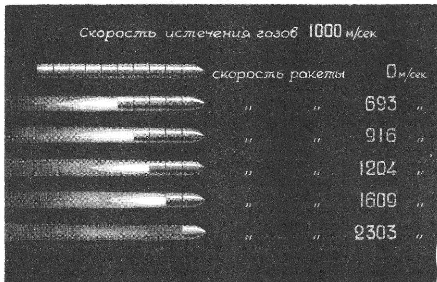
Рис. 18. Как увеличивается скорость ракеты в результате постепенного расхода топлива.
