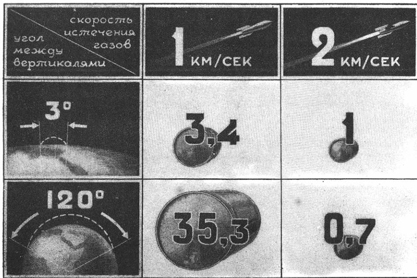
Рис. 23. Если скорость истечения газов для ракеты мала, то расход топлива на километр пройдённого на земле пути увеличивается с увеличением расстояния; если же эта скорость велика, то расход топлива на километр пути уменьшается с увеличением радиуса действия.
