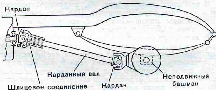
Рис. 60. Передача толкающих и скручивающих усилий рессорами (открытая карданная передача)
