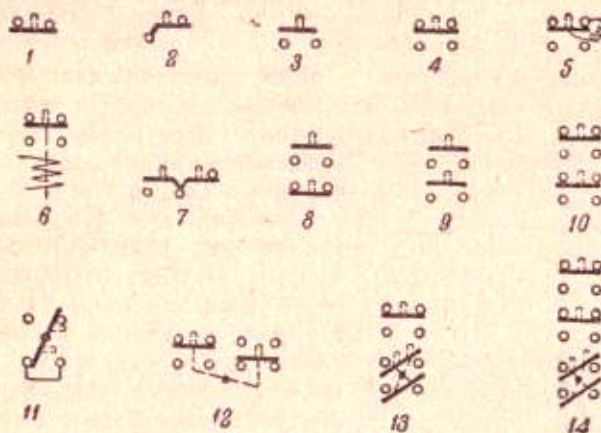
Рис. 131. Типичные схемы простейших кнопочных станций.
