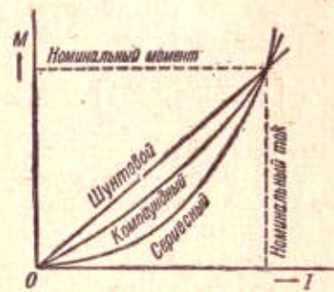
Рис. 20. Зависимость M=f(I) для разных типов двигателей постоянного тока.
