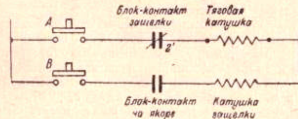
Рис. 122. Схема включения контактора с защелкой.
