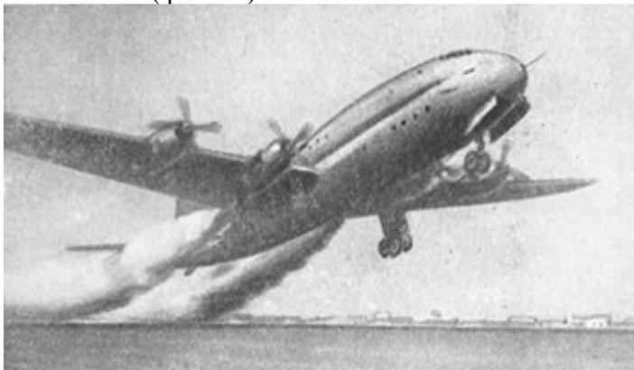
Фиг. 13. Взлет пассажирского самолета с помощью стартовых ракет (ракеты размещены в фюзеляже).
