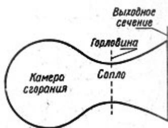
Фиг. 31. Изменение состояния газов в двигателе.
