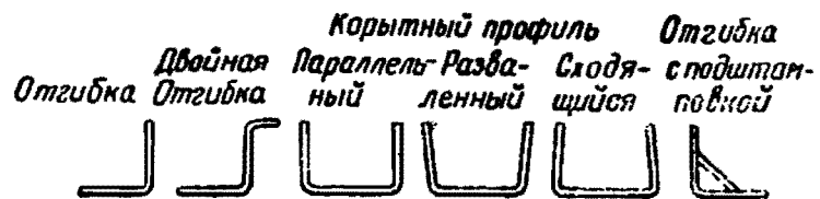
Фиг. 179. Усиление края детали отгибкой.
