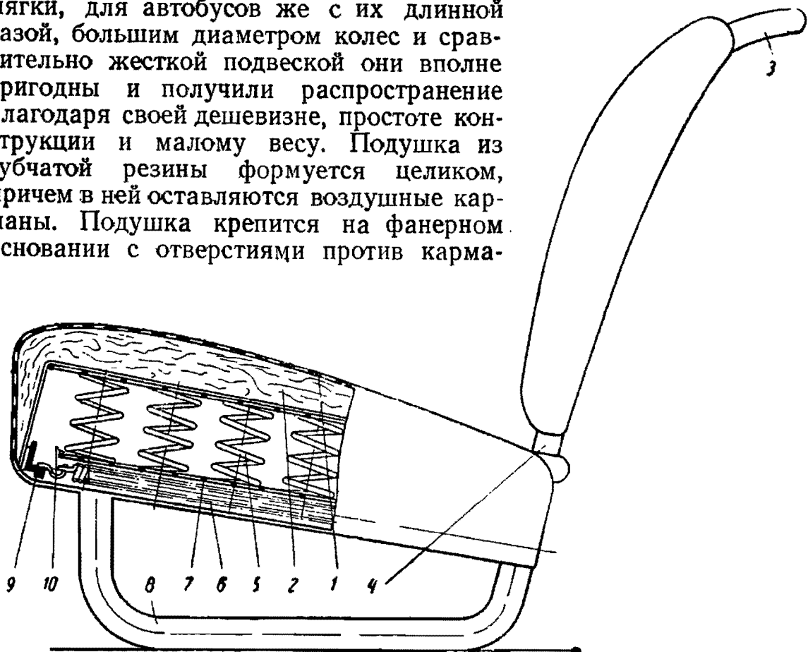
Фиг. 272. Схема сиденья водителя автомобиля „Москвич“:
