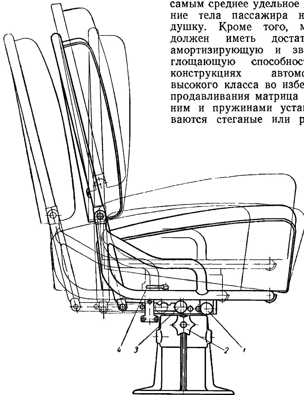
Фиг. 277. Сиденье водителя автобуса ЗИС-154:
