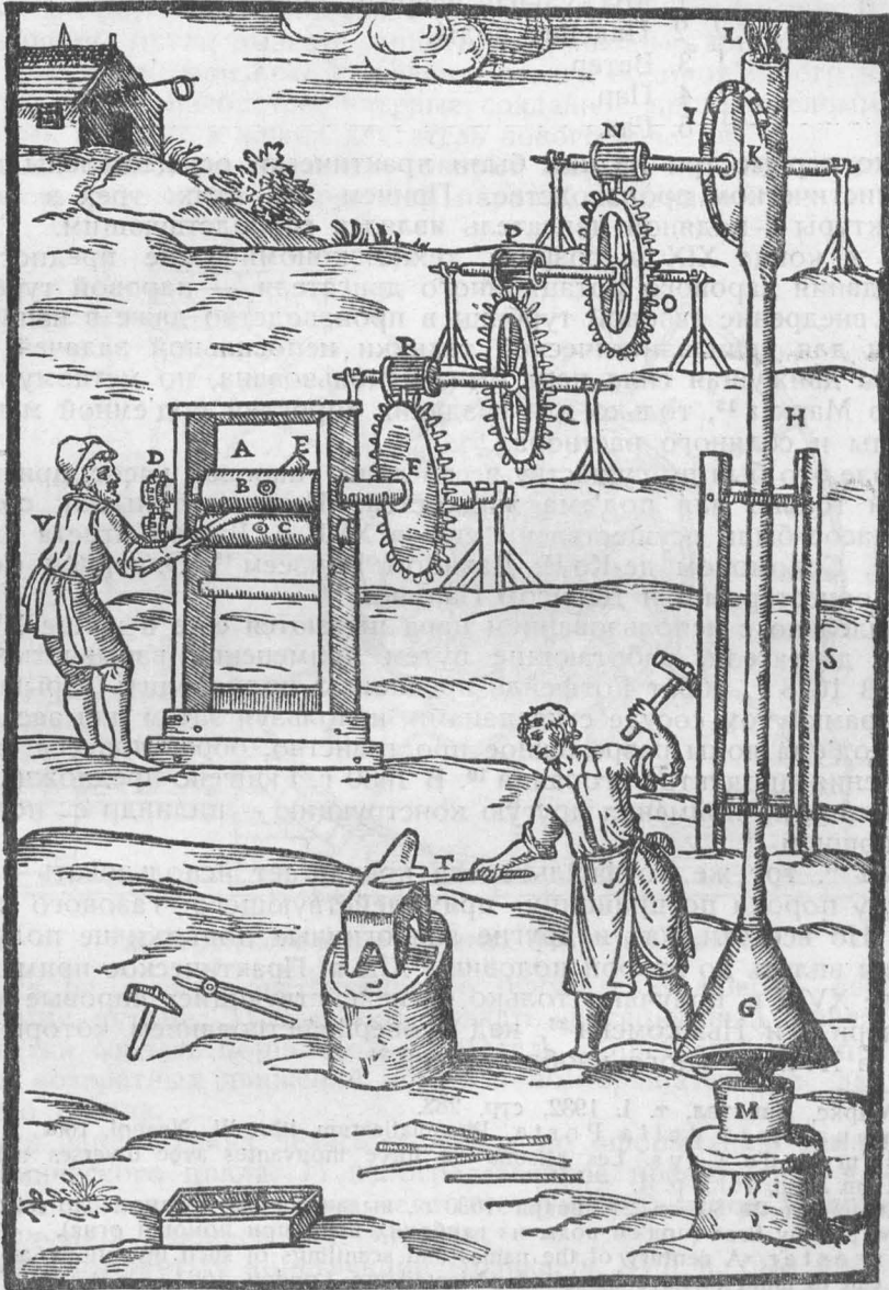
Рис. 2. Проект установки, использующей горячие газы кузнечного горна для вращения огненного колеса (I), приводящего в движение, при помощи системы зубчатых передач, вальцы для чеканки монет из золота, серебра, меди.
