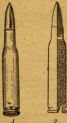
1—Боевой патрон. Внешний вид. 2—Разрез. Внутри виден заряд пороха.
