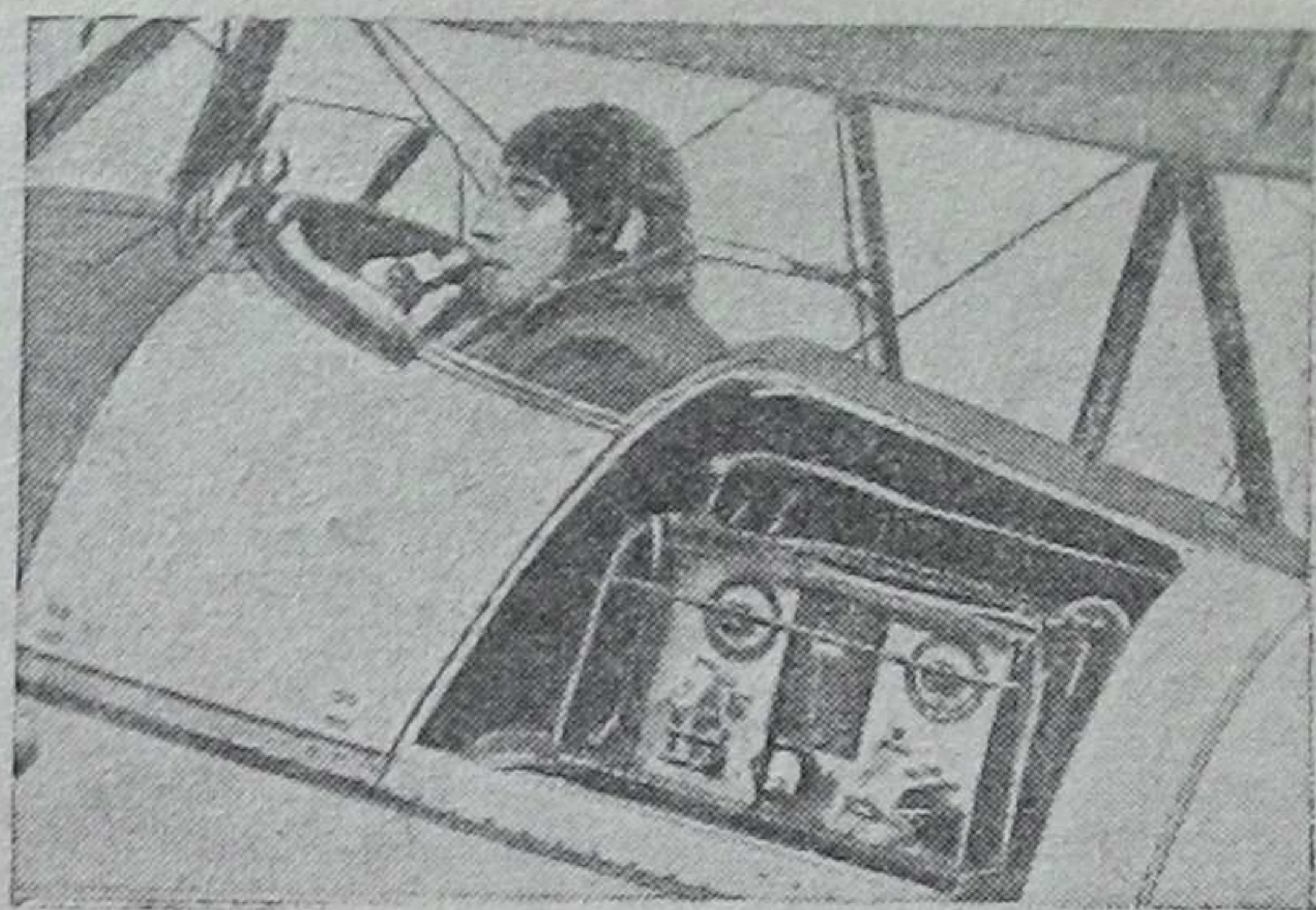
Рис. 3. Радиостанция типа АД-43/44 фирмы «Маркони» установленная на легком самолете в фюзеляже, доступ к радиостанции снаружи
