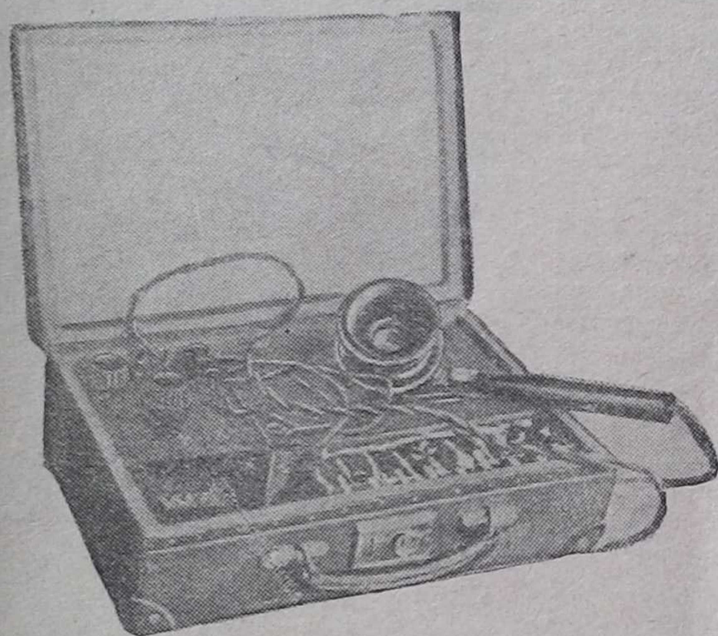
Рис. 1. УКВ-передатчик, смонтированный в чемодане
