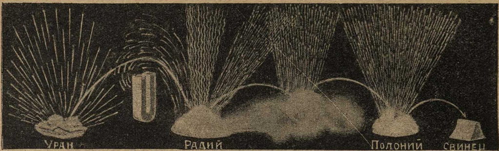
Самопроизвольное разрушение ряда радиоактивных элементов, сопровождающееся последовательным превращением одних элементов в другие и выделением продуктов распада. Рисунок схематически изображает генеологию радиоактивных элементов: урана, радия, полония и свинца. Продукты распада радия относятся к отрицательному полюсу электромагнита—атомы элемента гелия.
