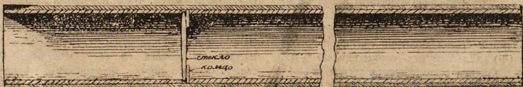
Рис. 2. Способ укрепления оправленных стекол в трубе.
