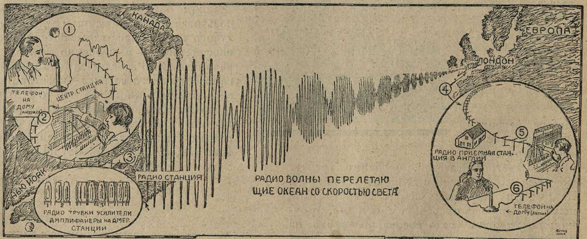
Схема включения домашних телефонов в сфере английских радиостанций направленного действия.
