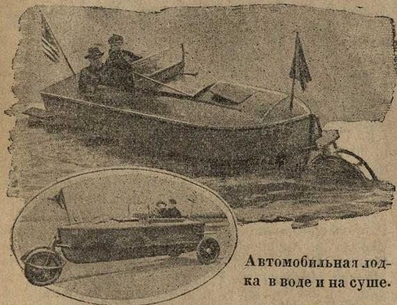
Автомобильная лодка в воде и на суше.
