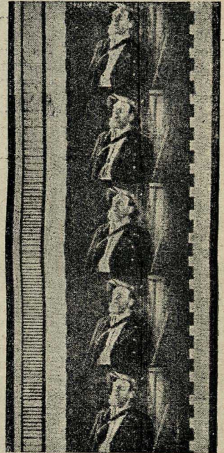
Говорящий фильм: справа изображение, слева фотограмма звуков, произносимых снятым лицом.
