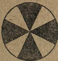
Рис. 2. Диск для определения скорости вращения вала двигателя
