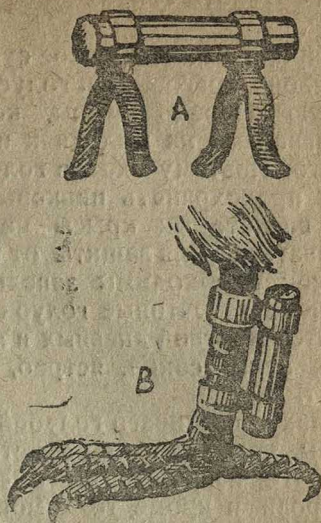
Прикрепление известия на ноге голубя. А—алюминиевая трубка с крючками. В—та же трубка, фиксированная на лапке голубя.
