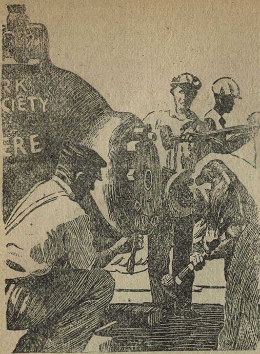
Завинчивание входного люка батисферы. Угасающий грохот терзает уши сидящих в батисфере. Завинчивание производится весьма тщательно во избежание катастрофы, подобной той, которая произошла с пустой батисферой (см. в тексте).
