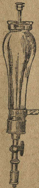
Рис. 1. Эвдиометр Г. Кэвендиша.
