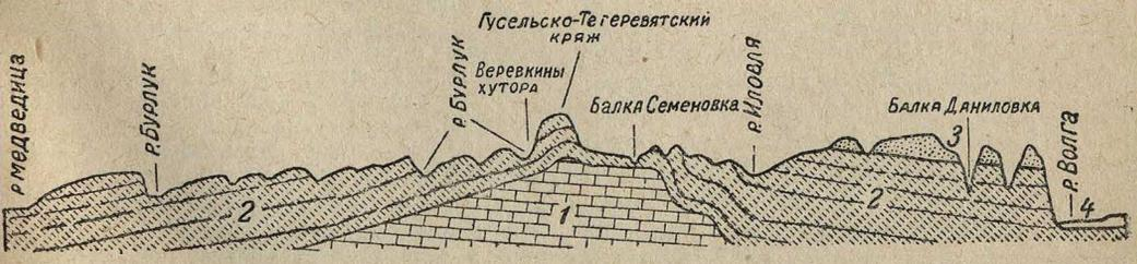
Рис. 12. Разрез Доно-Медведицкого вала. 1—каменноугольные породы; 2—мезозойские; 3—кайнозойские; 4—речной нанос.
