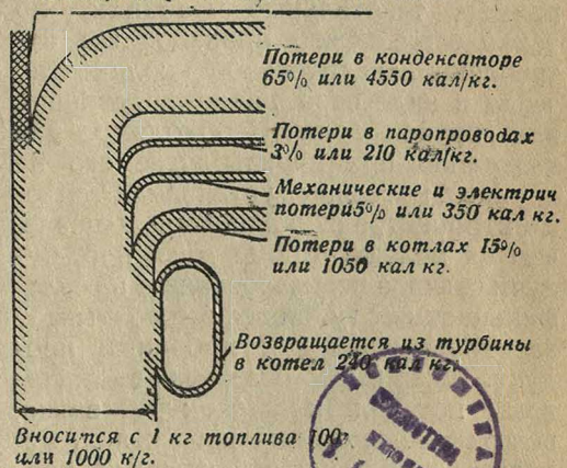
Рис. 2. Баланс распределения тепла на конденсационной станции.
