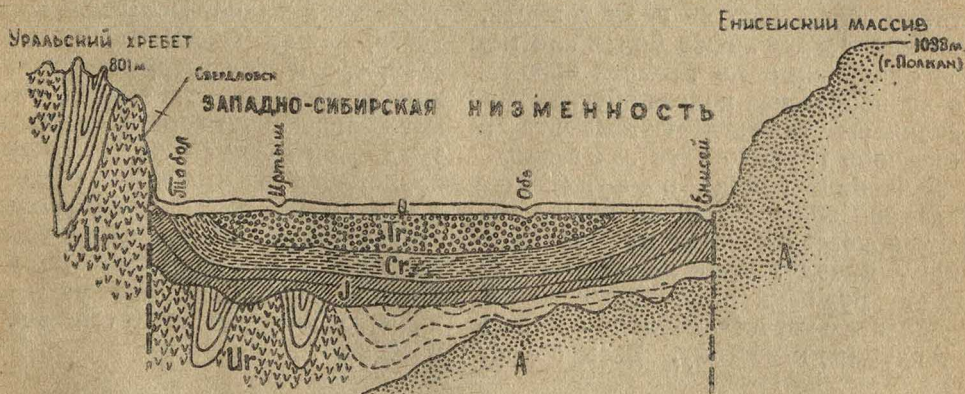
Гипотетический разрез Западно-Сибирской низменности. А — древнейшие кристаллические породы (археиды); Ur — уралиты (складчатые образования верхнепалеозойского орогенеза); J — юрские морские отложения; Cr — меловые отложения; Tr — третичные морские отложения; Q — четвертичные морские отложения; пунктир — разломы.
