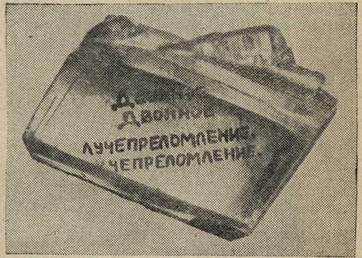
Рис. 1. Надпись, помещенная под кристаллом, вследствие двойного лучепреломления в кристалле исландского шпата, получается удвоенной.
