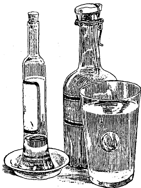
Масляный шарикъ виситъ внутри стакана съ разбавленнымъ спиртомъ.
