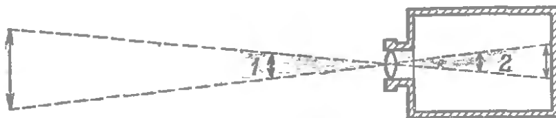
Рис. 121. В фотографическом аппарате угол 1 равен углу 2.
